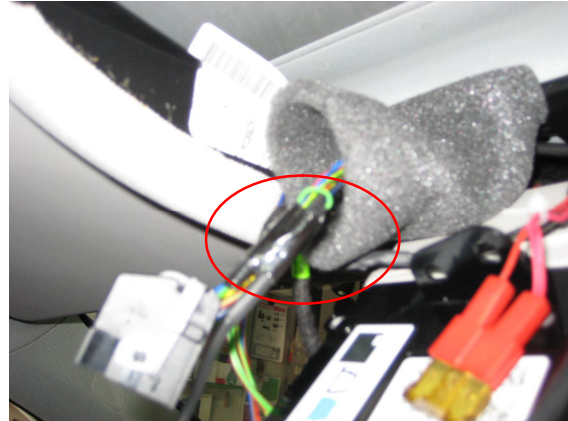
Toma de señal vía 13
