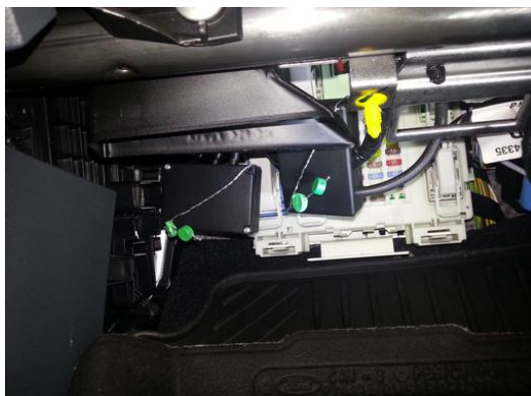
Mazo de cables en caja precintable
